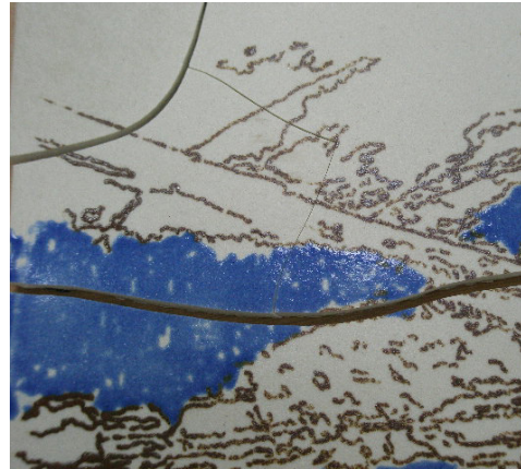
2006 年 雙釉印製窯溫過高陶版碎裂
