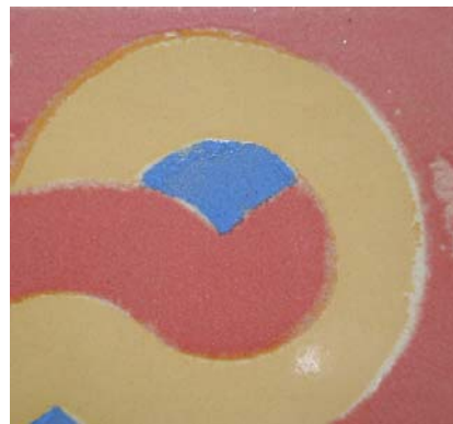
2006 年 三釉料套印顯色飽和卻仍局部脫釉
