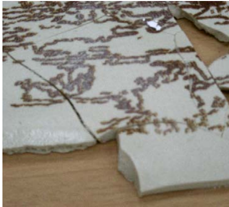
2006 年 單釉印製窯溫過高陶版碎裂
